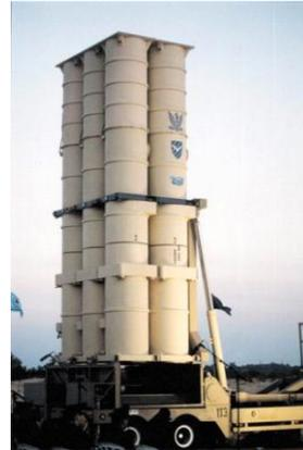
Figuras 14 y 15. Misil y lanzador del sistema Arrow
