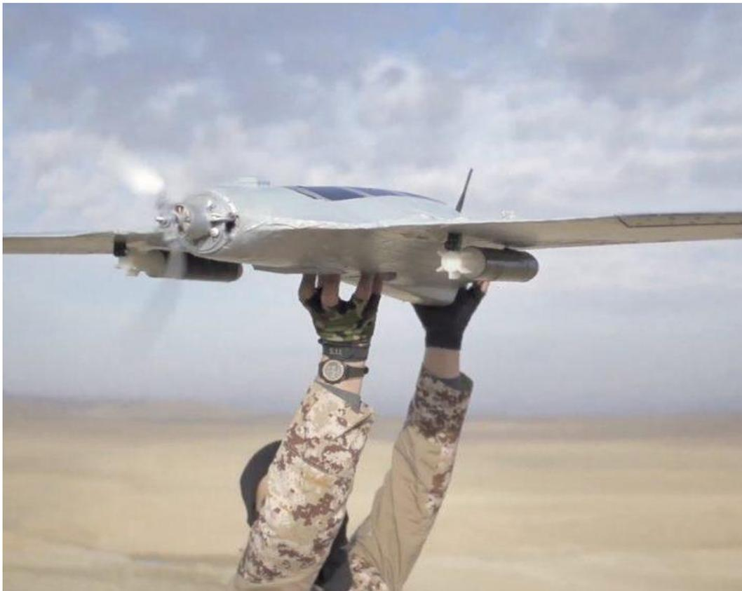
**Figura 6: Dron Skywalker X8 equipado con dos armas adaptadas de 40 mm.**
