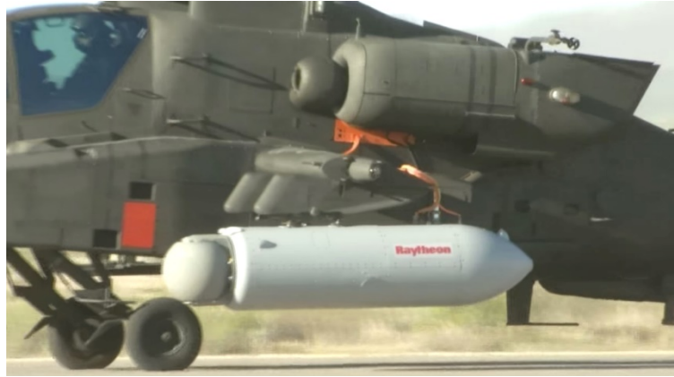
Figura 10. Detalle del sistema láser de Raytheon en un AH-64. Fuente:
