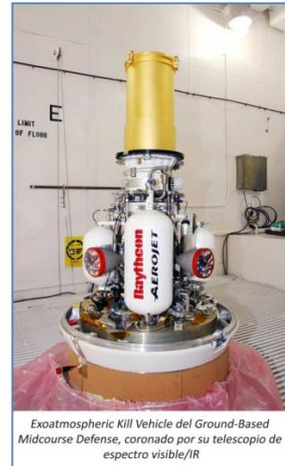
Exoatmospheric Kill Vehicle del Ground-Based Midcourse Defense, coronado por su telescopio de espectro visible/IR
