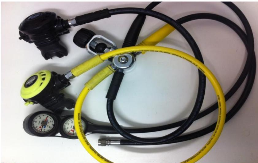
Un sistema actual de circuito abierto: Regulador INT completo con consola de instrumentos.
