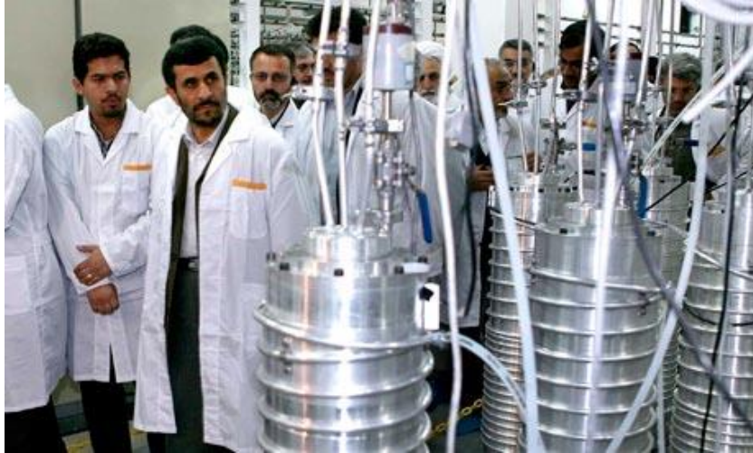
figura 13. Centrifugadoras de uranio de las centrales nucleares iraníes.
