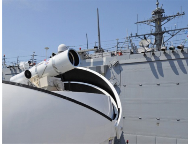
Figura 9. Prototipo de arma láser de estado sólido en el USS Ponce. Fuente: http://www.huffingtonpost.com/2013/04/09/us-navy-laser-weapon-deployed-uss-ponce-2014_n_3043244.html .
